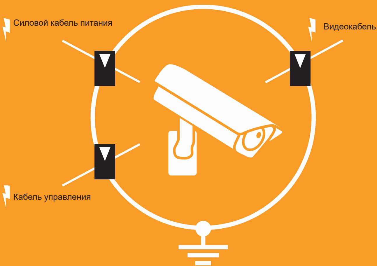
Для реализации всеобъемлющей концепции защиты от импульсных перенапряжений все части терминала или любого оборудования, способные переносить ток, должны быть включены в систему уравнивания потенциалов. В случае систем видеонаблюдения это различные интерфейсы, которыми оснащена видеокамера. В зависимости от версии, число варьируется от одного до трех.
